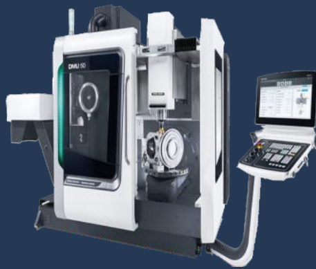
DMG MORI DMU 50(5-Axis) Qty:2, Accuracy: 6µm, X:600, Z: 500, Y: 510
