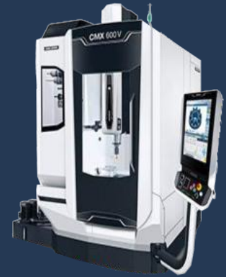
DMG MORI CMX 600 (4-Axis) Qty:2, Accuracy: 6µm, X:600, Z: 500, Y: 510
