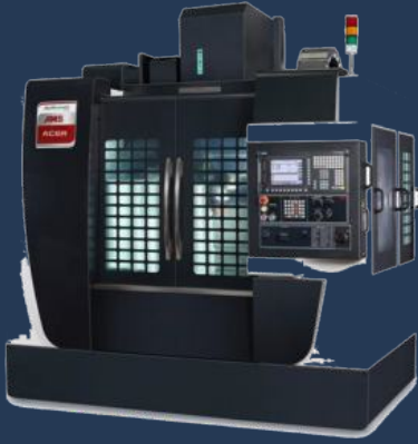
AMS Acer XL (5-Axis & 3-Axis) Qty:1, Accuracy: 15µm, X:800, Z: 500, Y: 500
